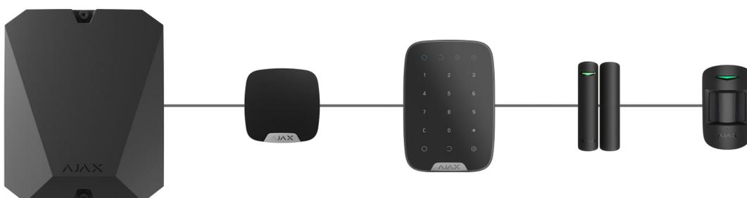
Bei der **Linientopologie** unbedingt einen 120-Ω-Abschlusswiderstand am Ende der Leitung installieren (im Lieferumfang der Hub-Zentrale enthalten). Der Abschlusswiderstand wird an die Signalklemmen des letzten Geräts der Linie angeschlossen.
